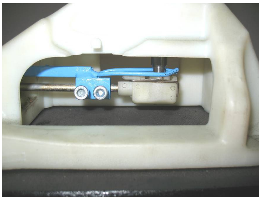
Рисунок 12. Подгибание усиков блокирующего элемента
