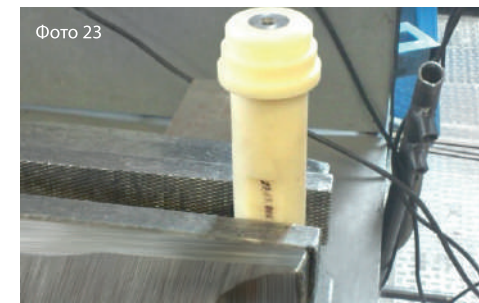
3.20. Установите приспособление для сверлений в слесарные тиски (Фото №23).
