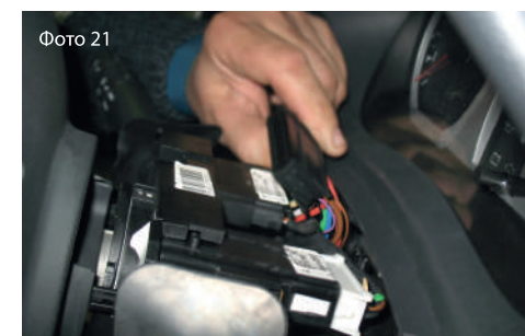
3.18. Подключите разъем проводов переключателя поворотов (Фото №21).
