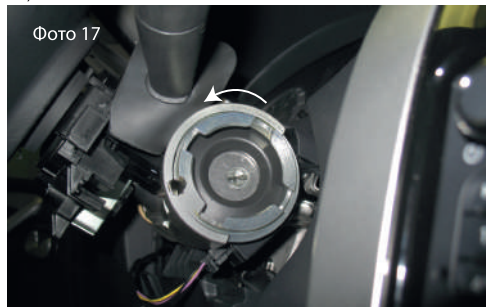
3.14. Проверните фланец в корпусе против часовой стрелки до совмещения отверстия в фланце и корпусе (Фото №17).
