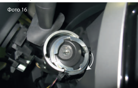
3.13. Совместите отверстие в фланце и верхнюю часть корпуса. Сориентируйте фланец в канавке корпуса. Заведите фланец в канавку корпуса, провернув его по часовой стрелке (Фото №16).
