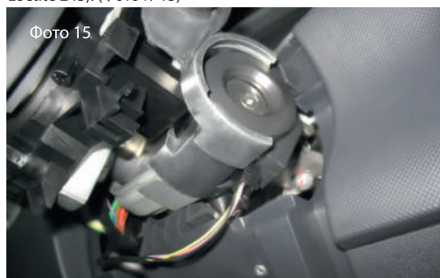
3.12. Сцентрируйте «Защиту корпуса» вокруг замка зажигания, установите на посадочные места катушку иммобилайзера и подключите разъем проводов (Фото №15).
