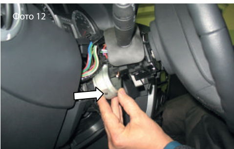
3.9. Закрутите винт М5 с использованием анаэробного герметика (типа Loctite 243) в хомут замка и установите хомут на рулевой вал (Фото №12).
