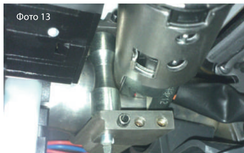
3.10. В хомут, установите втулку, закрепив ее осью фиксирующей, предварительно нанеся анаэробный герметик (типа Loctite 243). (Фото №13)
