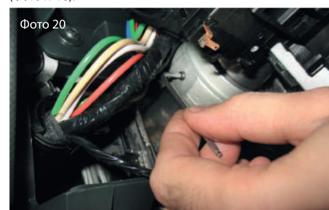
3.17. Затяните винт М5, для устранения люфта между «Защитой корпуса» и рулевым валом (Фото №20).
