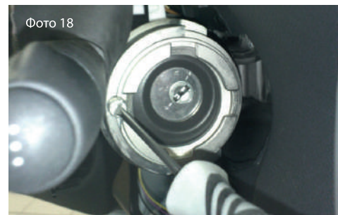
3.15. В резьбовое отверстие корпуса «Защиты корпуса» закрутите винт М5 до упора резьбы, предварительно нанеся анаэробный герметик (типа Loctite 243) (Фото №18).
