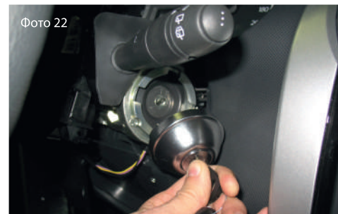
3.19. Установите «Защиту штатного замка» на фланец «Защиты корпуса». Подключите массовую клемму аккумулятора. Произведите проверку работоспособности устройства «Гарант Panzer» и штатного замка зажигания автомобиля. А так же всего электрооборудования автомобиля, в том числе и штатного иммобилайзера.
